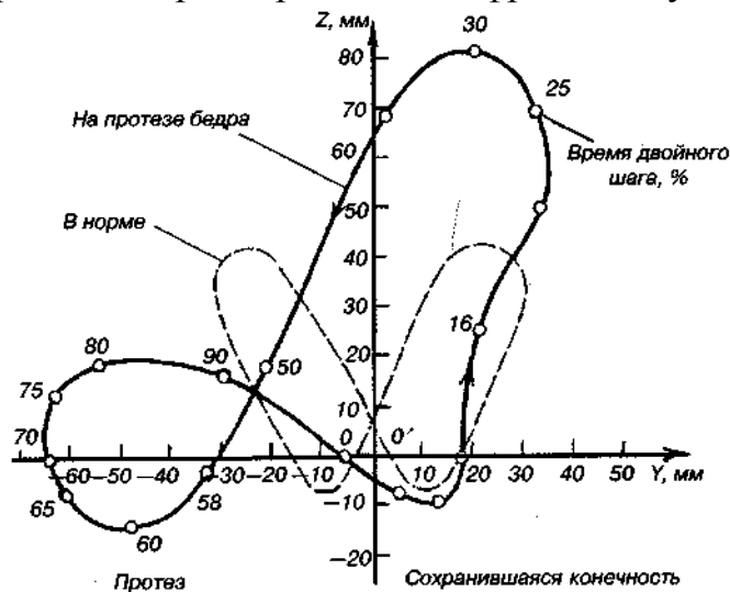
Рис. 18.53. Траектория ОЦМ человека при ходьбе в норме и на протезе бедра (по А.П. Кужекину и соавт., 1984)
